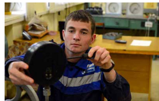
Павел Болдырев, слесарь по КИПиА, проводит работы по ремонту и калибровке средств измерения давления
