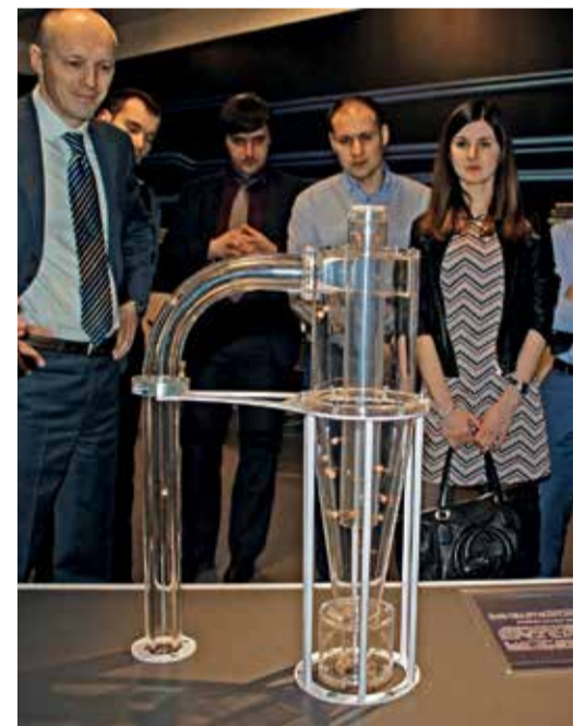
Интерактивный макет, демонстрирующий механизм очистки газа от механических примесей при магистральном транспорте газа
