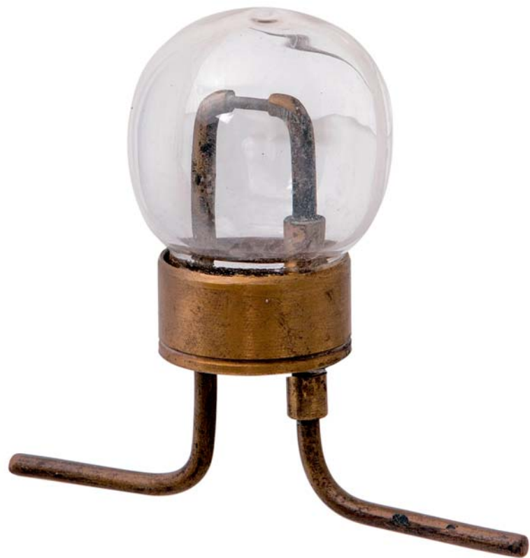
Лампа накаливания А.Н. Лодыгина. Телом накала служит тонкий стержёнок из ретортного угля, помещённый под стеклянным колпаком
